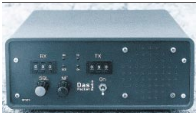
Bild 15: Blick auf die Bedienseite des betriebsbereiten Pa(c)ket-Radios mit den Nummernschaltern
