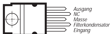
Bild 1: Pinbelegung (Kühlfläche mit Masse verbunden); Wärmewiderstand zwischen Kühlfläche und Sperrschicht max. 4 K/W
