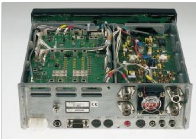
Die Rückansicht des FT-847 zeigt u.a. den ersten (ständig laufenden Lüfter) und die vier Antennenbuchsen für KW, 6 m, 2 m und 70 cm.
