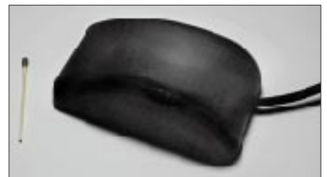
Bild 2: Der GPS-Empfänger wird magnetisch auf das Dach geheftet. Besitzer eines Fahrzeuges mit Aluminiumkarosserie (Audi) haben hier das Nachsehen.
